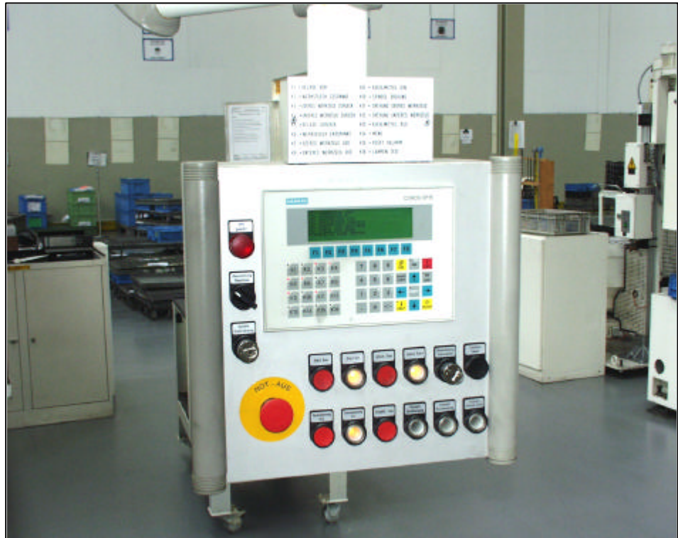
Bedienung und Überwachung der Schabmaschine (Bild: Kley, Tröller)
