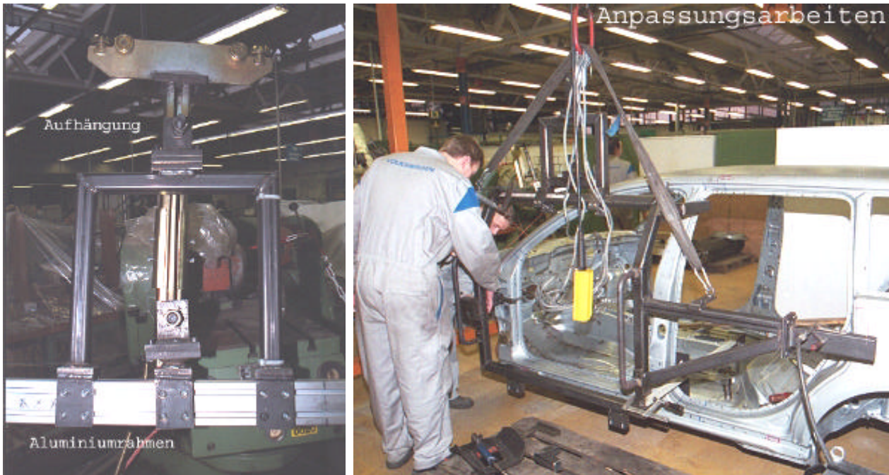
Bau/Entwicklung des Rahmens der Einbauvorrichtung
